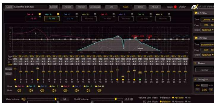
Im Hauptbildschirm werden Equalizer und Frequenzweichen eingestellt. Master- und Kanalpegel sind vorhanden und absolute oder relative Verlinkung von Kanälen sind dabei möglich
