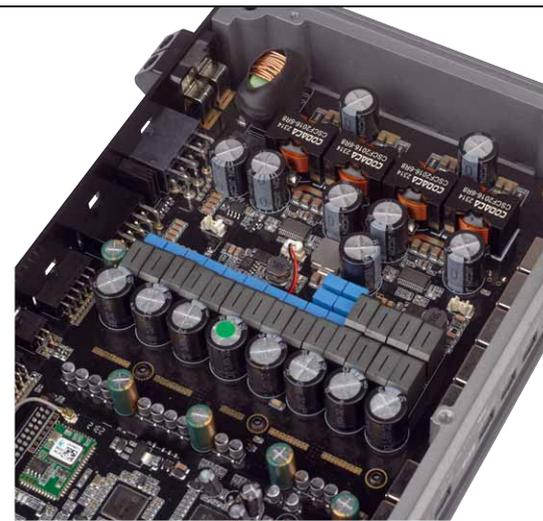
Die 4 Spulen oben gehören zum Step-up Netzteil
