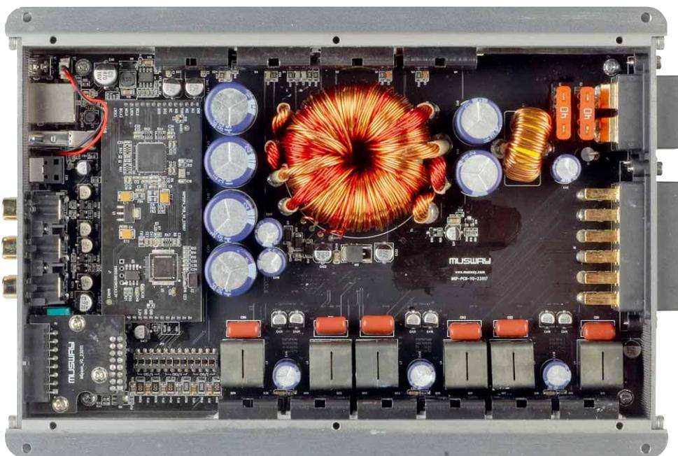
Das massive Trafonetzteil versorgt 6 gleiche Kanäle, die über MOSFETs befuehren
