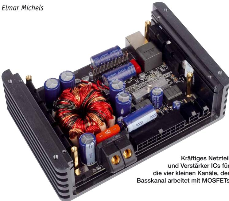
Kräftiges Netzteil und Verstärker ICs für die vier kleinen Kanäle, der Basskanal arbeitet mit MOSFETs
