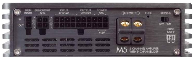
Die M5 bietet vier prozessierte Ausgänge und zwei RCA Buchsen für den AUX-Eingang. Die Lautsprecher docken über einen Molex Verbinder an
